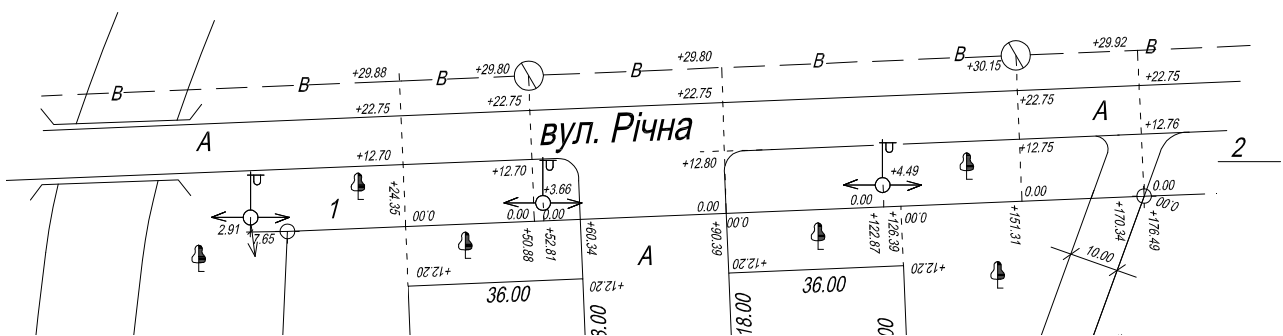
Рис. 3.7 - Складання плану теодолітної зйомки
